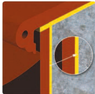
Грунтовка и гидроизоляция основы
